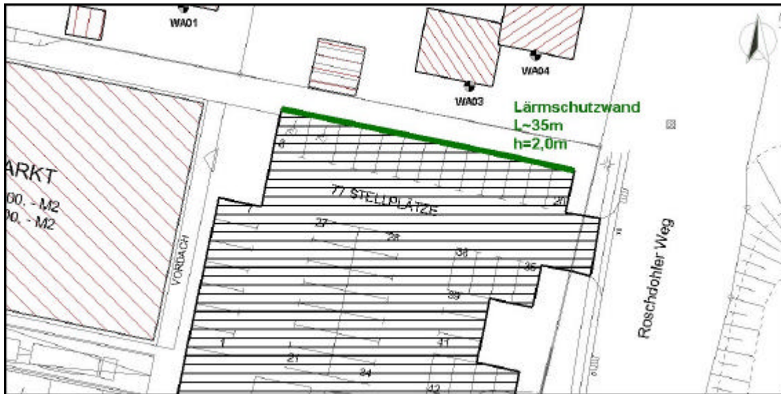
Bild 3.1: Planfall 2 – Ausbildung der Lärmschutzwand
