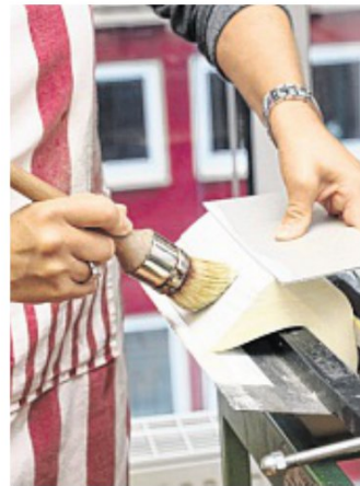
... wird der Rücken mit Leim bestrichen, zusammengepresst...
