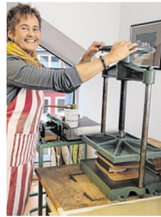
...in den Einband gedrückt und in die Buchpresse gelegt.
