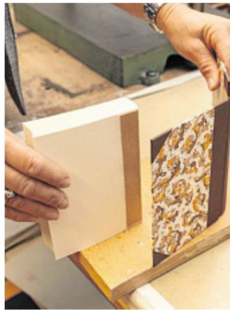
Damit der Buchblock in den Einband kommt...
